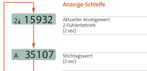
Der doprimo 3 ready zeigt Ihnen die erfassten Messwerte im fünfstelligen LC-Display in gut lesbaren Zahlen an. So können Sie jederzeit Ihren Verbrauch selbst kontrollieren. Sie aktivieren das LC-Display des doprimo 3 ready durch kurzes Drücken der Taste am Heizkostenverteiler. Im Zwei-Sekunden Rhythmus wechselt nun die Anzeige zwischen dem aktuellen Wert und dem Stichtagswert.
